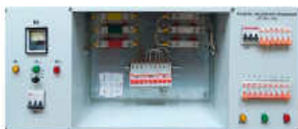
Рис. 2. Стенд «Фазировка электрического оборудования»
